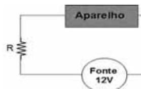
Considerando a corrente do circuito igual a  $500 \text{ mA}$ , qual deve ser o valor da resistência  $R$ , em  $\Omega$ , para que o aparelho não seja danificado?
